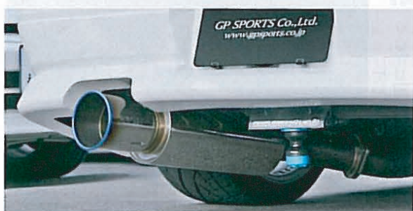
ジャッキポイントはネジ込み式で、メインの写真でもわかる通りに、先端が十字型になっていてシザースジャッキのヘッド部にフィットするようになっている。こんなポイントも「わかってるな」と感心させられる
